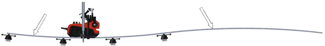
TRAC RL auf Flex-Führungsschiene montiert, Schweißen auf einer gewölbten Ebene
