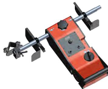
Schneiden mit Wärmeschutzschild
